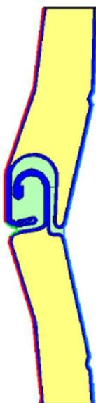
Si consideri un avvolgibile costituito in un caso da profilati in alluminio ed un caso in acciaio, entrambi con riempimenti in poliuretano espanso rigido. I valori di trasmittanza termica e di resistenza ottenuti dal software di simulazione sono i seguenti:
