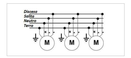
La lunghezza massima del cablaggio fra interruttore e motore WT non deve superare i 50 mt Non utilizzare un cavo multipolare per comandare più motori WT da un unico cavo Ogni motore WT deve essere collegato ad un suo proprio cavo
